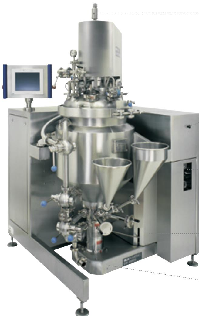
Вращающееся подсоединение к спиральной или противоточной мешалке для нагревающей/охлаждающей жидкости
